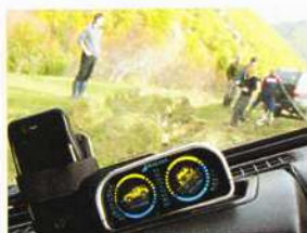
Un tipico inclinometro analogico.
