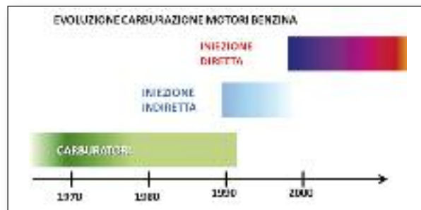
Sui motori a benzina automobilistici, i carburatori hanno ceduto il passo all'iniezione elettronica per ridurre l'emissione di inquinanti. L'affidabilità è oggi pari o superiore ai vecchi sistemi meccanici.
