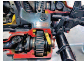
Potete azionare la leva in alto e inserire la trazione anteriore, con la leva gialla che spinge il manicotto. Al secondo scatto si spingono le leve di entrambi i blocchi. Tutto meccanico! Goduria!
