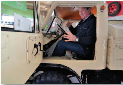
Sigfried ci mostra come si "entra" negli Unimog, aiutandosi con il tamburo zigrinato sulla ruota (in emergenza anche verricello). Scendere è più difficile: ma era fatto apposta, per lavorare di più, ci dice sorridendo!
