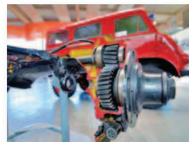
Sogno quasi irraggiungibile: cascata d'ingranaggi sul mozzo per il ponte a portale. Luce a terra di oltre 40 cm, alta riduzione, alberi e semiassi più leggeri!
