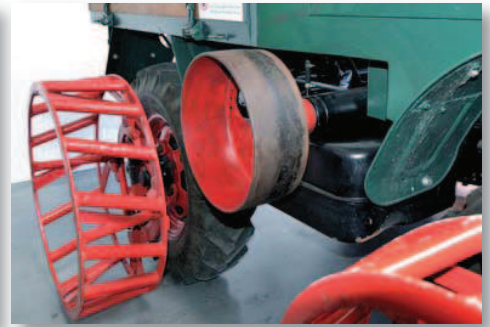
Rara la terza presa di forza laterale (a richiesta fanno ancora tutto!). Ruote gemellate da fango estremo! Sigfried ci spiega che non c'erano soldi per pneumatici diversi! Evviva la crisi!
